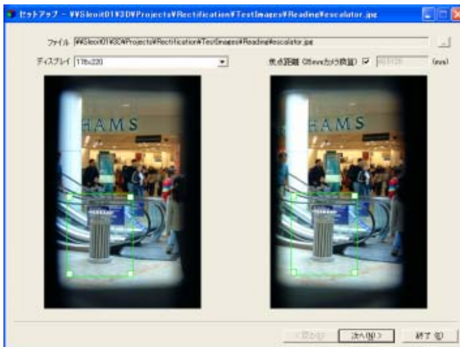
図 10: この図のような枠の設定では枠が小さすぎて良い結果が期待できません。画像を選択する枠は図 6 のようになるべく大きく取るのがコツ。
