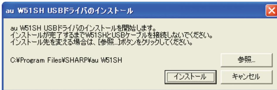
インストールフォルダ（デフォルト「C : ¥Program Files¥SHARP¥au W51SH」）を変更する場合は [参照] をクリックしてください。フォルダを指定した後、[OK] をクリックしてください。
