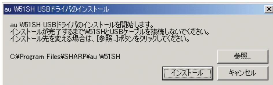
インストールフォルダ（デフォルト「C : ¥Program Files¥SHARP¥au W51SH」）を変更する場合は [参照] をクリックしてください。フォルダを指定した後、[OK] をクリックしてください。
